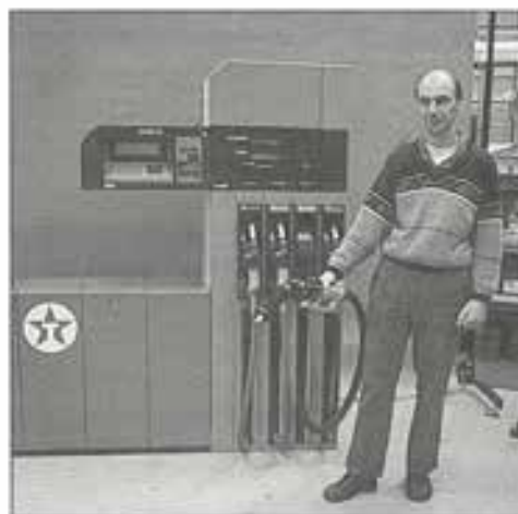
Pumparna i SU 900-serien är de första av våra produkter som kommer att tas fram med utgångspunkt från kvalitetssystem ISO 9001. Jan-Allan Johansson, Specialverkstaden, demonstrerar SU 934C ("C" för integrerad korthantering) i Texaco-utförande.
